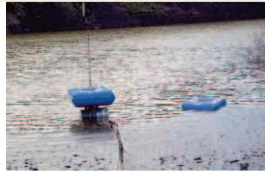
Gut verankert: Die meisten Pumpenhersteller haben spezielle Schwimmpontons für Tauchmotorpumpen im Programm.
