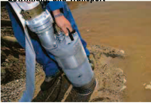
Tauchmotorpumpen, die viele Hersteller als „Baupumpen“ vertreiben, sind für die Wasserhaltung in Kiesgrube und Steinbruch gut geeignet.
