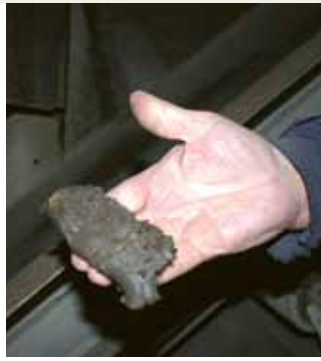
Das Salz in der Suppe: Die Braunkohleeinschlüsse im Ton sind deutlich zu erkennen, ohne sie würde die Leichtschamotteaufbereitung nicht funktionieren.
