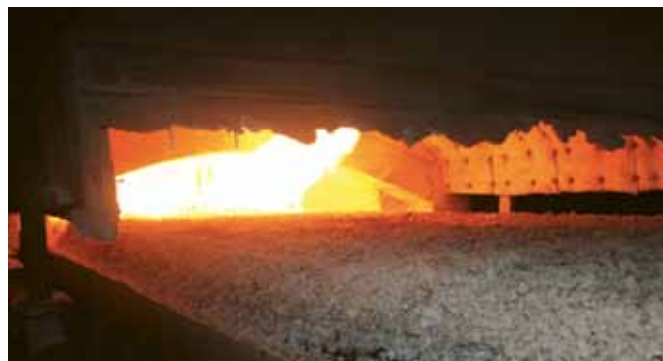
Einblicke in den Tunnelofen: In der Sinteranlage geht es bei Temperaturen von 1 200° heiß her.
