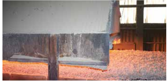
Frisch gebacken: Hart- und Leichtschamotte werden nun durch einen besonderen Mechanismus voneinander getrennt und dann zum jeweiligen Aufbereitungsprozess transportiert.
