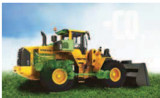
Der Volvo L220F Hybrid verfügt über kombinierte elektrische Motor-Generatoren, die in den Antriebsstrang integriert sind.
