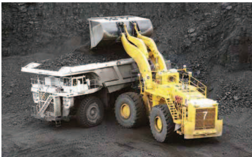
Der beim Bremsen gewonnene Strom der Radlader von LeTourneau unterstützt die Hydraulik beim Heben des Hubarms. Das senkt den Kraftstoffverbrauch um bis zu 40 %.
