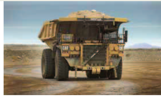
Der Cat 793F ist mit dem brandneuen „Command for Hauling“ ausgestattet und kommt gänzlich ohne Fahrer aus. Foto: Caterpillar
